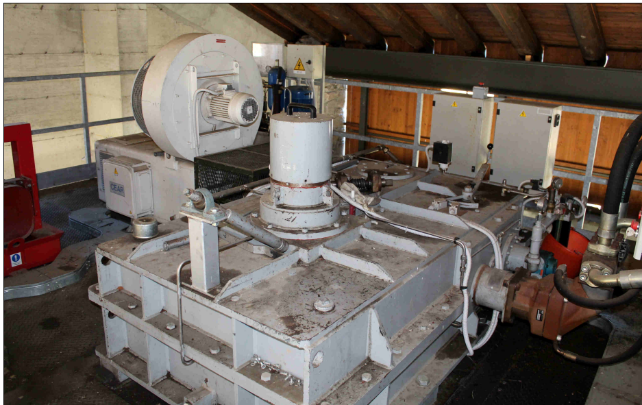
Riduttore epicicloidale CAT, con ingresso principale da motore elettrico sul lato sinistro e ingresso secondario sul lato destro con motore idraulico dell'argano di riserva
