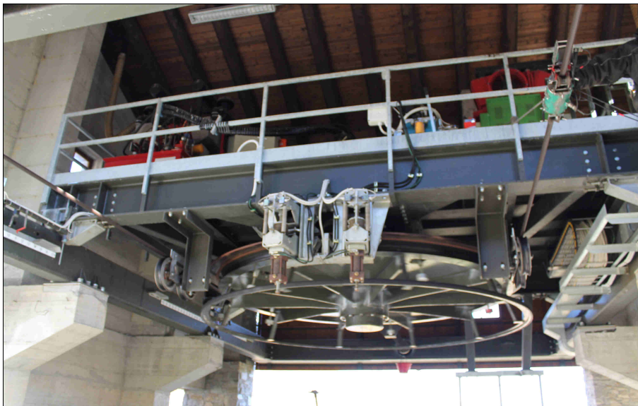
Vista della sala macchine al di sopra del carrello di tensionamento
